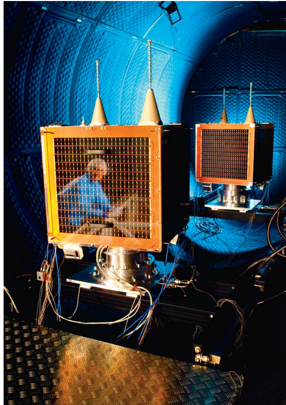
UK-DMC: ラザフォード・アップルトン研究所で真空環境テストに入るUK-DMCとNigeriaSAT-1 DMCの衛星
