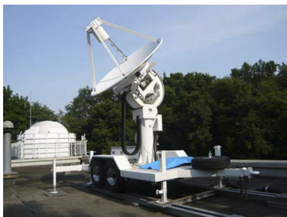
図 1 2.4m アンテナ外観
